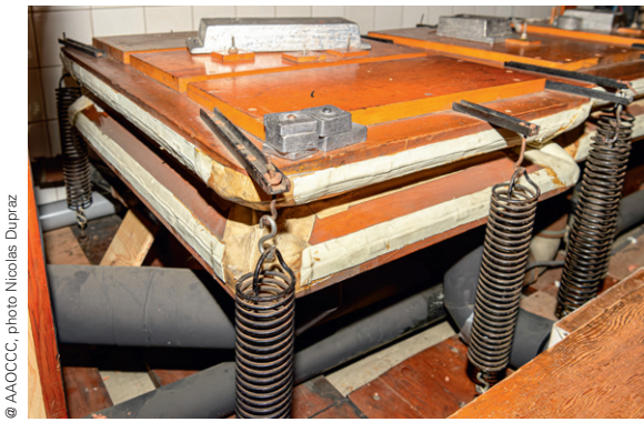
Fig. 10 Un soufflet régulateur, donnant la pression exacte pour une section de l'instrument. Le cuir – d'origine – a été déjà plusieurs fois rapiécé.
